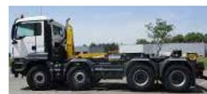
→ Bras **S21** monté sur châssis TGS 26460 6x4 .....
