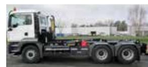
→ Bras **T20** monté sur châssis TGS26460 6x2 .....
