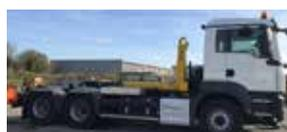
→ Bras **P24A** monté sur châssis TGS35460 8x4 .....
