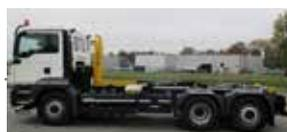
→ Bras **T20** monté sur châssis TGS 26460 6x4 .....
